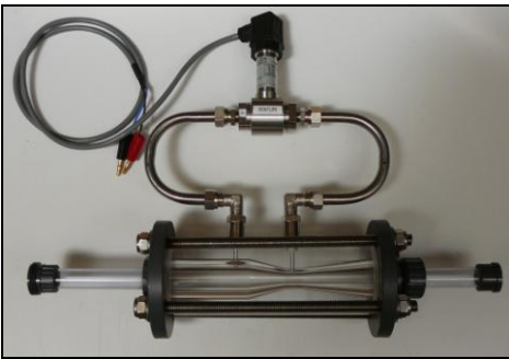
Débitmètre à venturi
