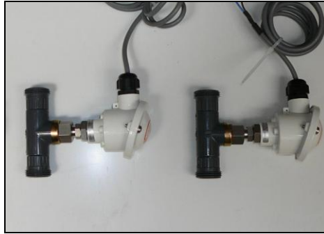
Capteurs de température
