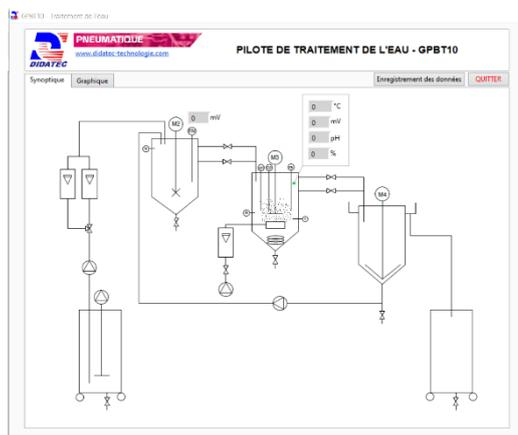
On retrouve dans cette fenêtre le synoptique de la machine avec la localisation des différentes mesures du processus et leurs valeurs.
