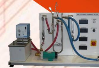
Banc d'échanges thermiques mono tubulaire
