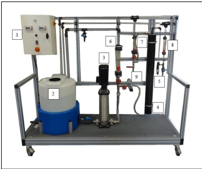
1 : Coffret électrique, 2 : Cuve d'alimentation, 3 : Pompe multicellulaire, 4 : Membrane d'osmose inverse, 5 : Cellule de conductivité, 6 : Débitmètre de recirculation, 7 : Débitmètre de concentrat, 8 : Débitmètre de perméat, 9 : Manomètre
