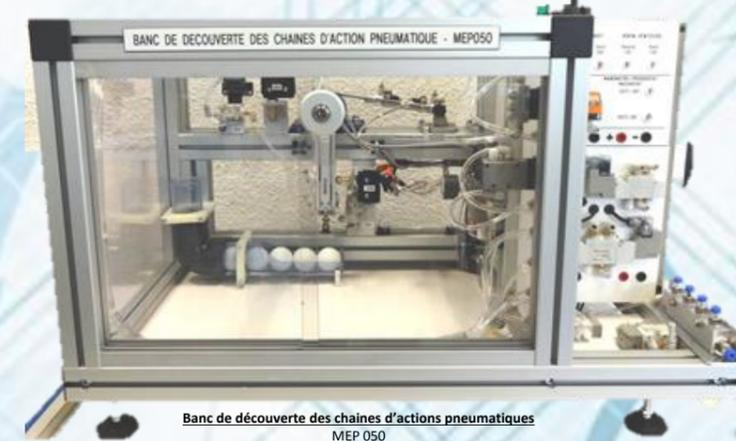
Banc de découverte des chaînes d'actions pneumatiques MEP 050
