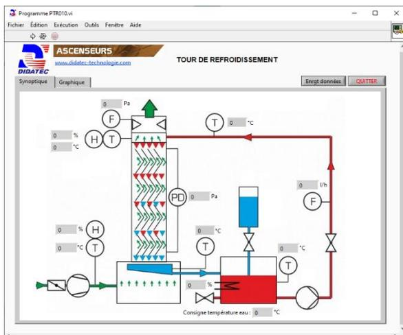
On retrouve dans cette fenêtre le synoptique de la machine avec la localisation des différentes mesures du processus et leurs valeurs.
