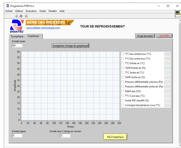
On retrouve dans cette fenêtre graphique, la possibilité de tracer des courbes de mesures en fonction du temps en sélectionnant les grandeurs souhaitées.
