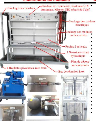
1 POSTE DE TRAVAIL avec stockage arrière & bac de rétention. Pilotage de la centrale hydraulique associée, gestion de la sécurité, distribution des commandes électriques poussoirs/commutateurs ou sous forme de cycles automatisés via un API (logiciel et cordon fourni). Un afficheur LCD assure la fonction d'IHM pour sélectionner l'un des programmes fournis avec leurs schémas de câblage, paramétrer une consigne en Tr/min, mm, ml/min ou bars & visualiser la grandeur physique mesurée correspondante
