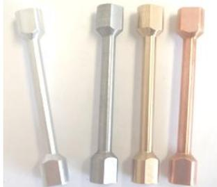
**En option :** des éprouvettes cylindriques de diamètre 10mm en acier, aluminium, cuivre, laiton peuvent également vous être proposées sur demande :
